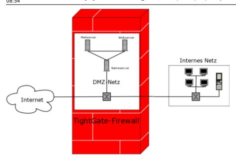
Der Sinn der DMZ ist es, möglichst auf sicherer Basis Dienste des Rechnerverbundes sowohl dem einem als auch dem anderem Netz zur Verfügung zu stellen. Ein typisches Anwendungsbeispiel ist das Betreiben eines eigenen TightGate-Pro Servers.
