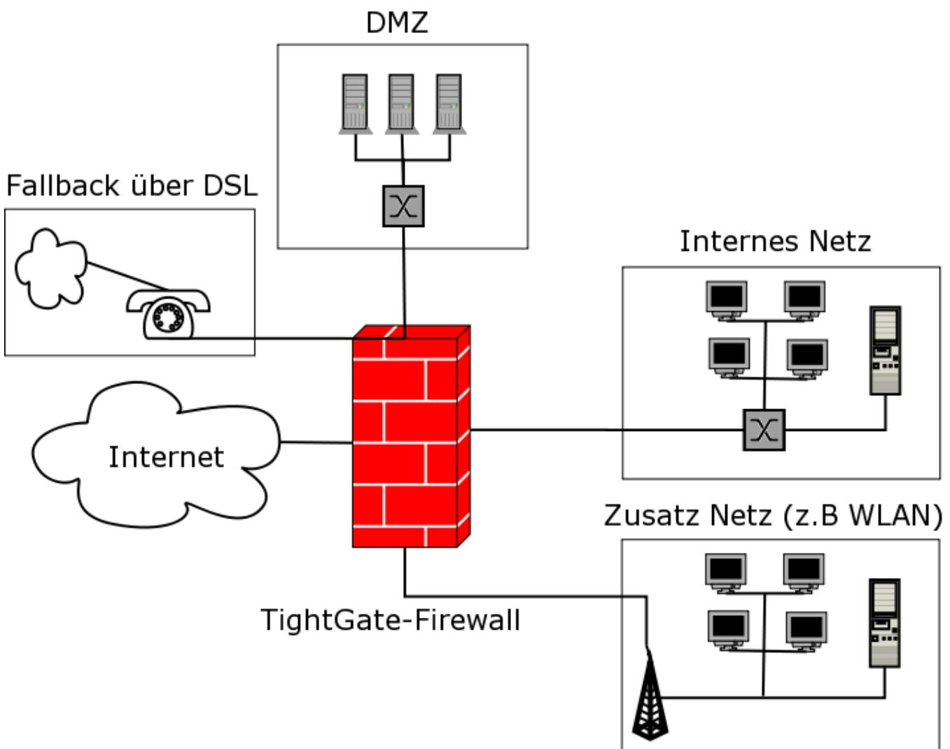
In der Standardausführung besitzt die mp-Firewall bis zu fünf vorkonfigurierbare Netzwerk-Anschlüsse. Damit können zwei interne Netzwerke, eine DMZ, ein externes Netz (Internet) und ein Fallback (Internet für Notfälle) angebunden werden. Weitere Schnittstellen können Sie über "Custom Rules" hinzufügen. Sollten Sie in Ihrem Netzwerk einen [TightGate-Pro Server](#) betreiben, so wird dieser üblicherweise in der DMZ aufgestellt. Zusätzlich zur IP-Filterfunktionalität bietet die mp-Firewall noch
