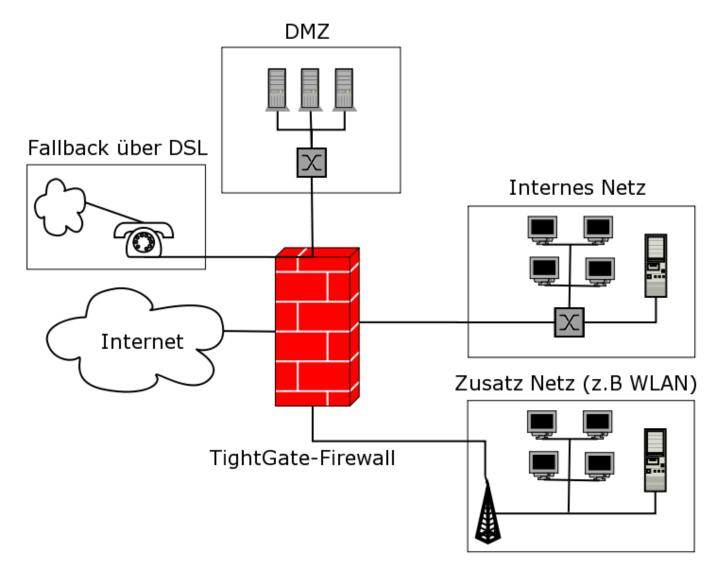
In der Standardausführung besitzt die mp-Firewall bis zu fünf vorkonfigurierbare Netzwerk-Anschlüsse. Damit können zwei interne Netzwerke, eine DMZ, ein externes Netz (Internet) und ein Fallback (Internet für Notfälle) angebunden werden. Weitere Schnittstellen können Sie über "Custom Rules" hinzufügen. Sollten Sie in Ihrem Netzwerk einen TightGate-Pro Server betreiben, so wird dieser üblicherweise in der DMZ aufgestellt. Zusätzlich zur IP-Filterfunktionalität bietet die mp-Firewall noch
