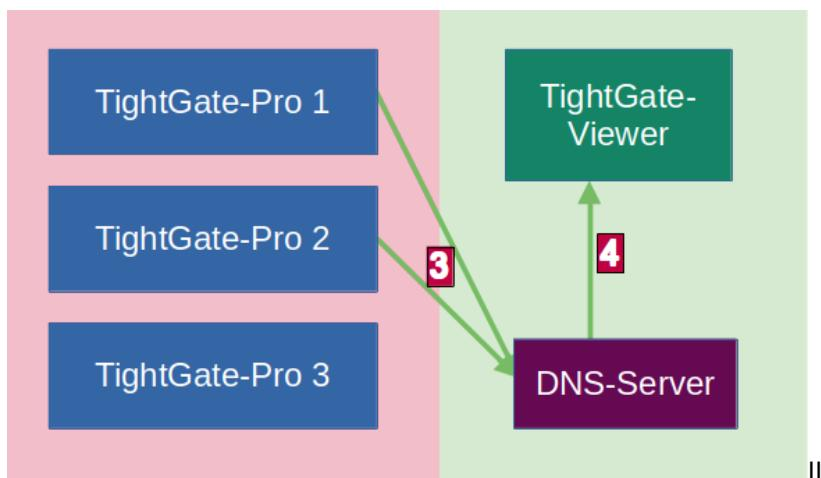
Als Antwort bekommt der DNS-Server in Schritt **3** die Antwort vom TightGate-Pro Loadbalancer, welche TightGate-Pro Server zur Verfügung stehen (im Beispiel TightGate-Pro 1 und 3). Aus dieser Antwort wählt der DNS-Server einen aus (im Beispiel TightGate-Pro 3) und gibt diesen im Schritt **4** an den TightGate-Viewer weiter.
