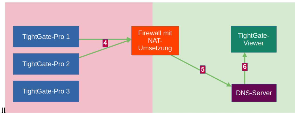
Die TightGate-Pro Loadbalancer antworten im Schritt **4** dem DNS-Umsetzer, welche TightGate-Pro Server aktuell zur Verfügung stehen. Dabei gibt TightGate-Pro als Rückgabe auf die Anfrage gleich die richtigen **LAN-IP-Adressen** zurück (im Beispiel TightGate-Pro 1 und 3, was den IP-Adressen 192.168.1.100 und 192.168.1.103 entspricht). Diese Adressen leitet der DNS-Umsetzer im Schritt **5** an den internen DNS-Server und dieser weiter im Schritt **6** an den TightGate-Viewer.
