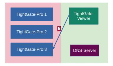
Im Schritt **5** stellt der TightGate-Viewer eine Verbindungsanfrage zur IP-Adresse des zurückgegebenen TightGate-Pro Servers.
