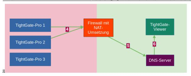
Die TightGate-Pro Loadbalancer antworten im Schritt **4** dem DNS-Umsetzer, welche TightGate-Pro Server aktuell zur Verfügung stehen. Dabei gibt TightGate-Pro als Rückgabe auf die Anfrage gleich die richtigen **LAN-IP-Adressen** zurück (im Beispiel TightGate-Pro 1 und 3, was den IP-Adressen 192.168.1.100 und 192.168.1.103 entspricht). Diese Adressen leitet der DNS-Umsetzer im Schritt **5** an den internen DNS-Server und dieser weiter im Schritt **6** an den TightGate-Viewer.
