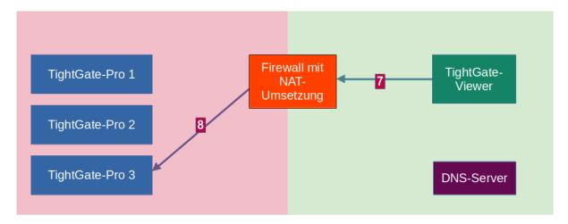
Der TightGate-Viewer kann nun im Schritt **7** eine Verbindungsanfrage mit der richtigen LAN-Adresse des verfügbaren TightGate-Pro Servers stellen (im Beispiel 192.168.1.103). Der NAT-Umsetzer weiß, dass für die Adresse eine NAT-Umsetzung auf die NAT-Adresse von vom TightGate-Pro 3 (im Beispiel 10.10.10.103) zu erfolgen hat und stellt die Verbindung im Schritt **8** her.
