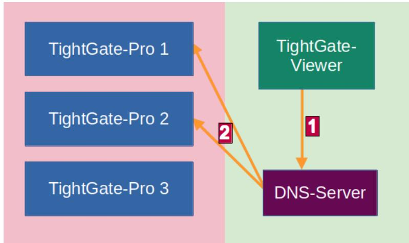
Im Schritt **1** fragt der TightGate-Viewer den DNS-Server an, zu welcher IP er sich verbinden soll, wenn er eine Verbindung zum Server mit dem Namen **internet.intern.netz** aufbauen möchte. Diese Anfrage kann der DNS-Server nicht selber beantworten, sondern befragt im Schritt **2** die Loadbalancer des TightGate-Pro Clusters (im Beispiel TightGate-Pro 1 und 2), welche Server zur Verfügung stehen.
