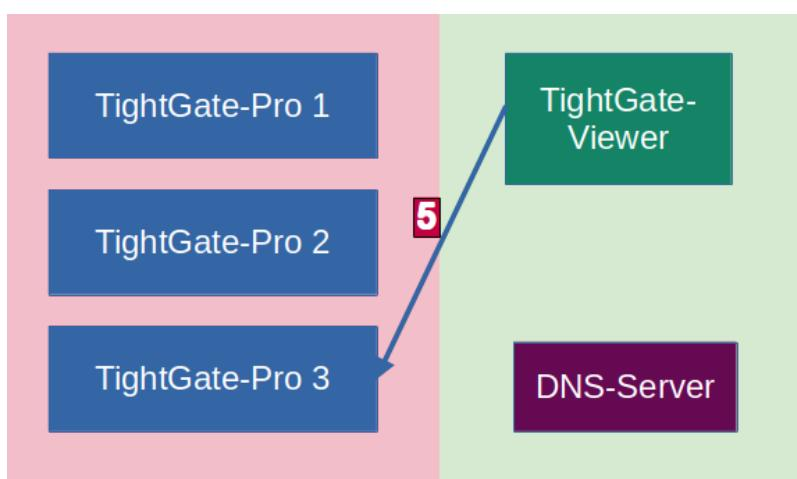
Im Schritt **5** stellt der TightGate-Viewer eine Verbindungsanfrage zur IP-Adresse des zurückgegebenen TightGate-Pro Servers.
